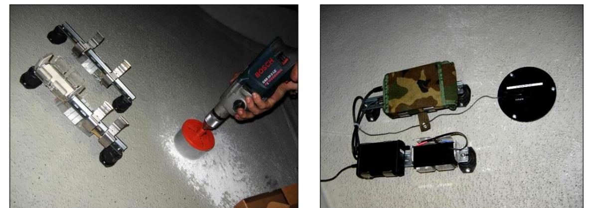
**Figure 42 : Exemple d'installation d'un batcorder dans une nacelle (avec perforation de la paroi de la nacelle pour la mise en place du micro)**
