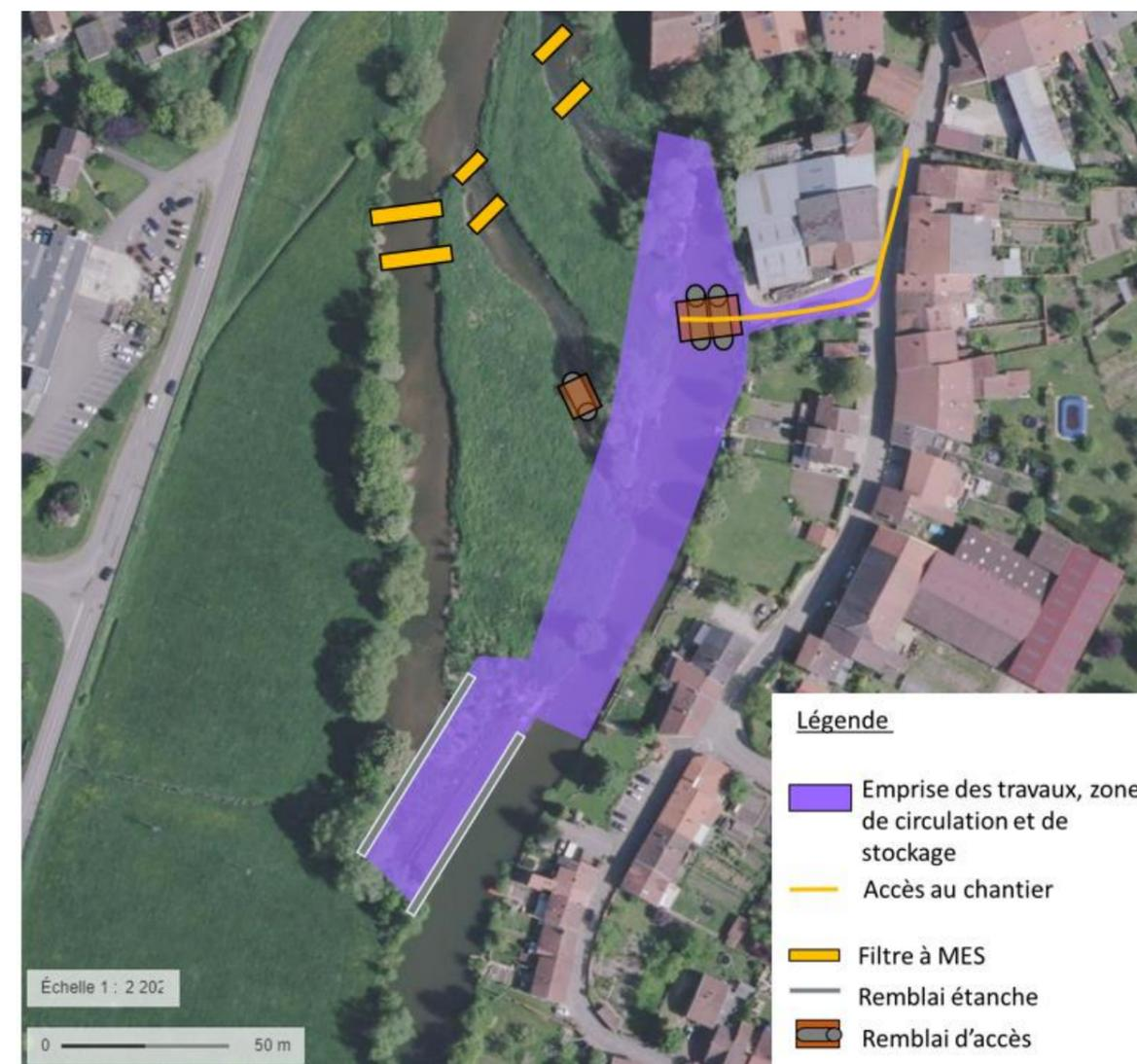
**Fig. 109. Localisation des emprises et accès au chantier sur l'opération 6**
