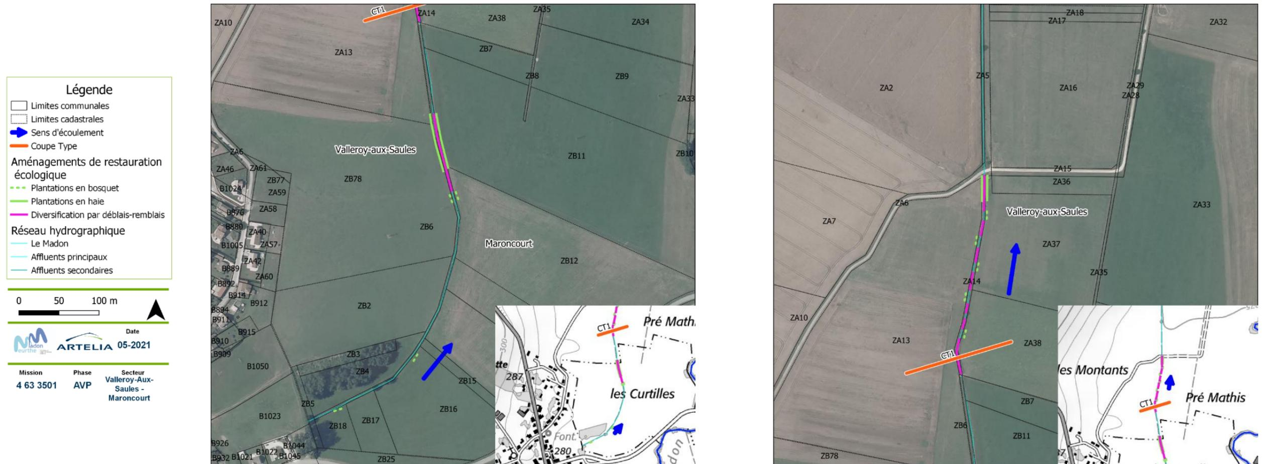
Fig. 60. Carte des aménagements de restauration écologique sur l'affluent en rive gauche du Madon – secteurs amont (gauche) et central (droite)
