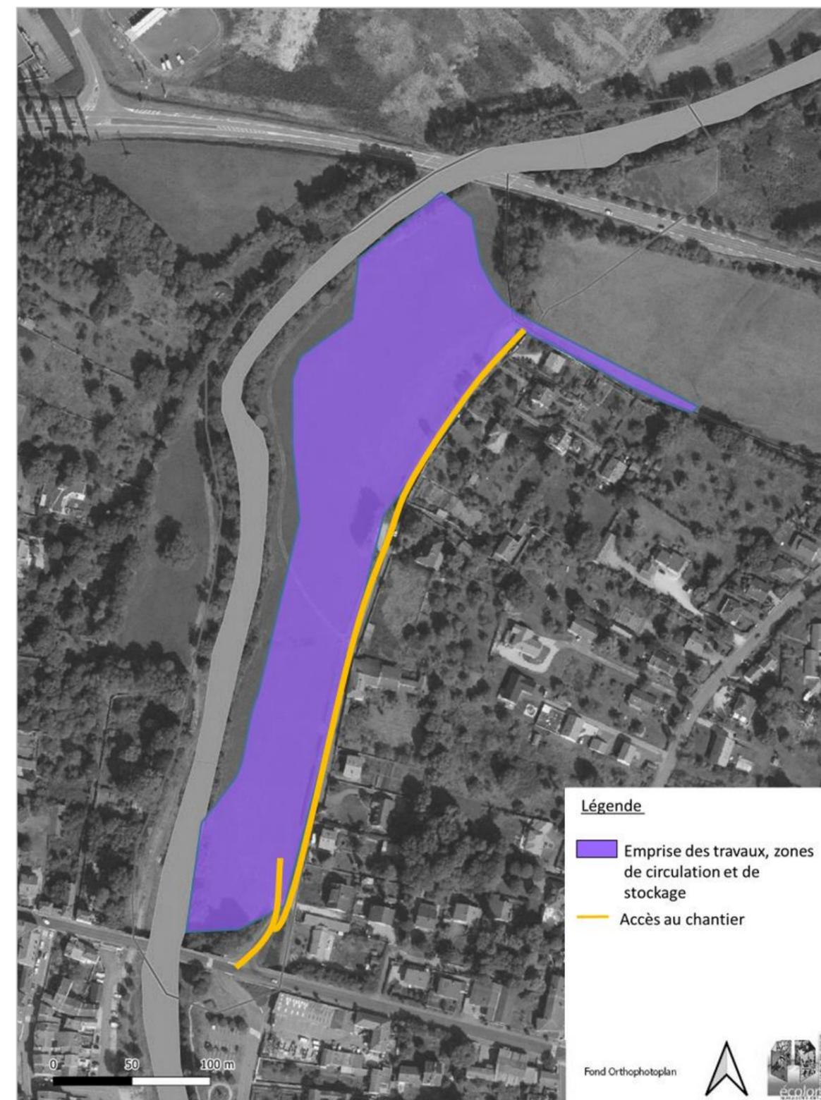
**Fig. 77. Localisation des emprises et accès au chantier sur l'opération 4**
