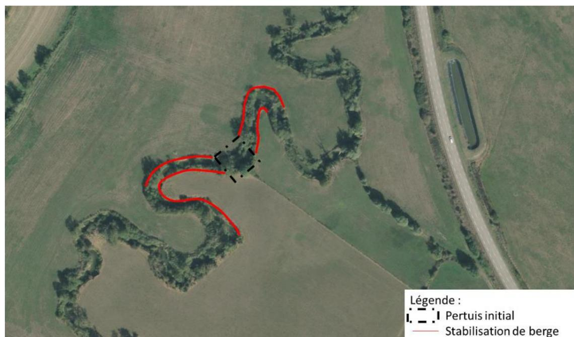
**Fig. 55. Stabilisation de berge à mettre en place pour sécuriser les méandres et l'aménagement pour le positionnement initial.**
