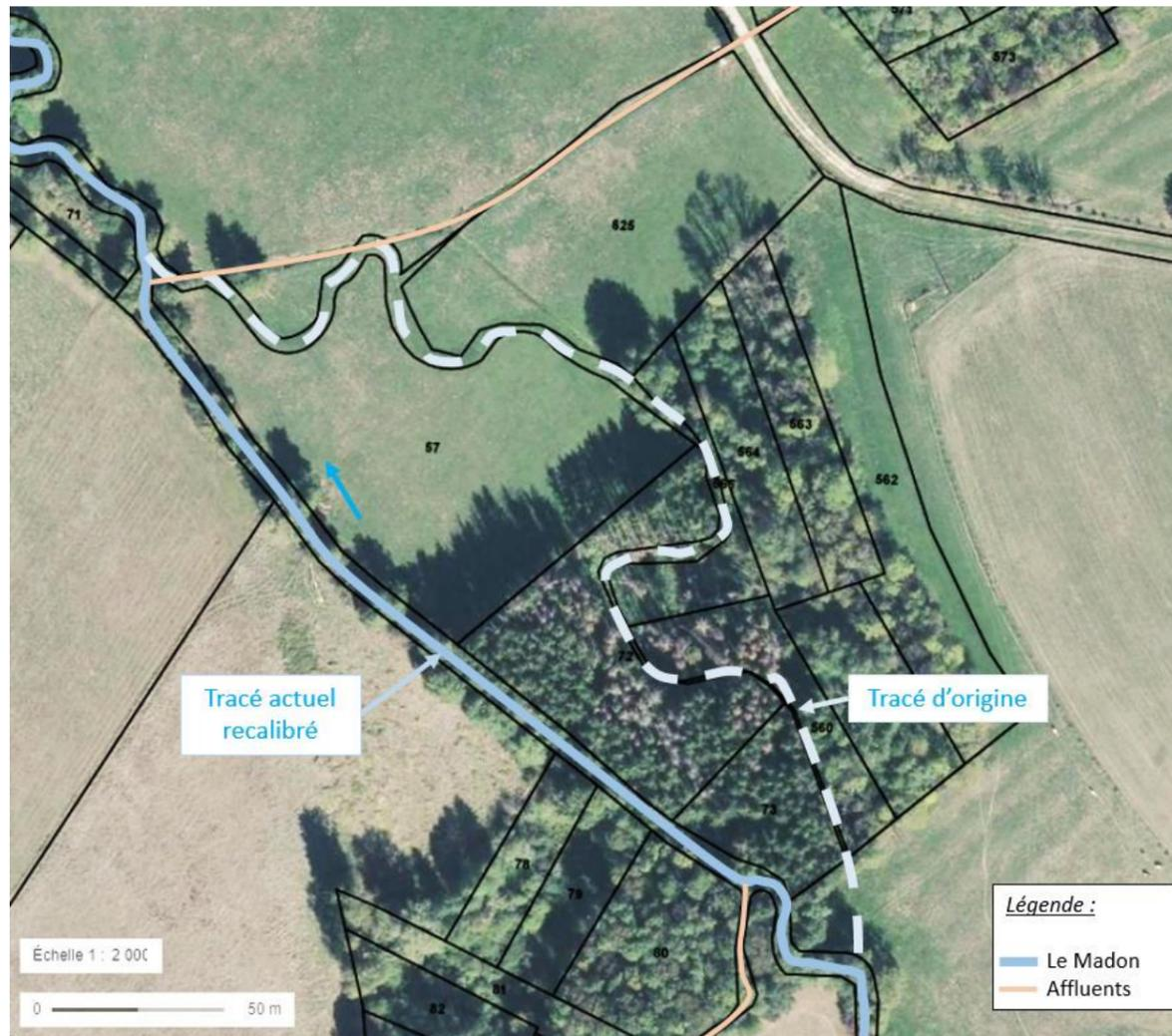
Fig. 46. Photographie aérienne du tronçon du Madon concerné par le reméandrage en l'état actuel (source : géoportail, modifié)
