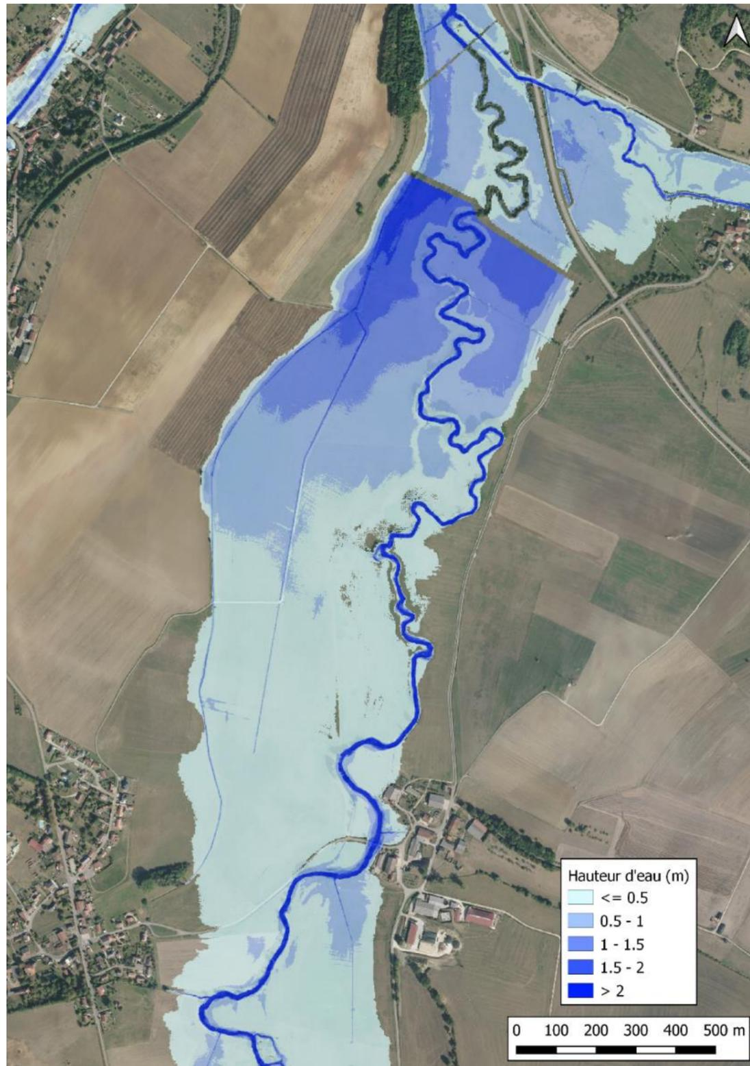
Fig. 41. Opération 1 - Cartographie des hauteurs d'eau - Crue décennale, état aménagé
